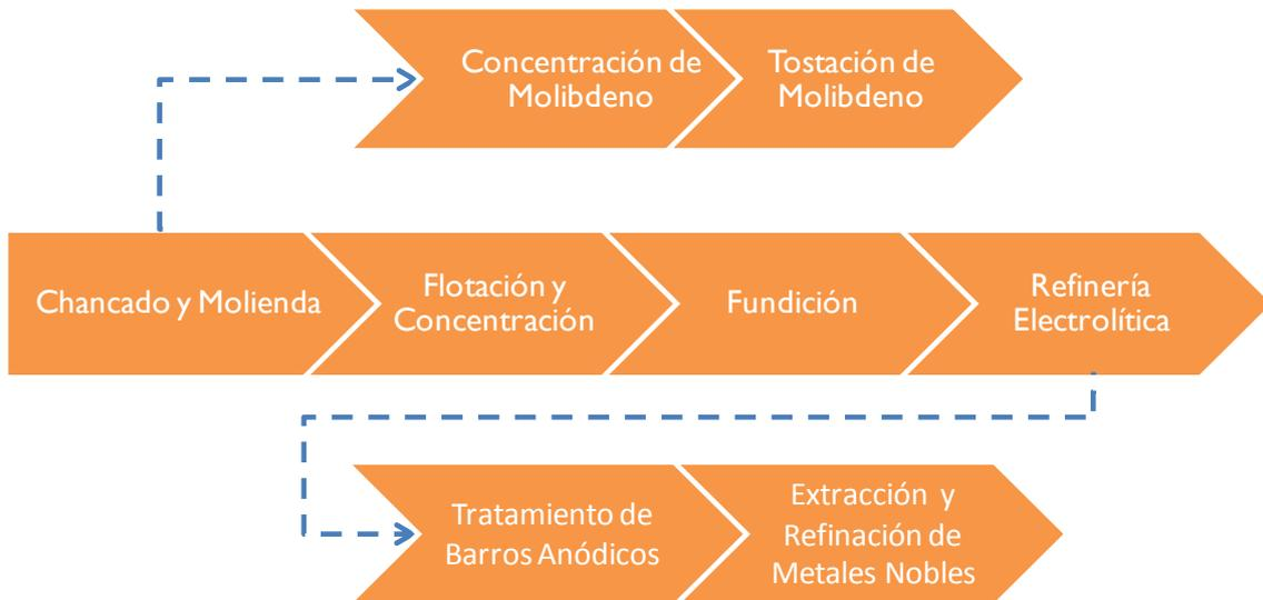
*Ilustración 39: Línea de Procesamiento de Sulfuros de Cobre.*
